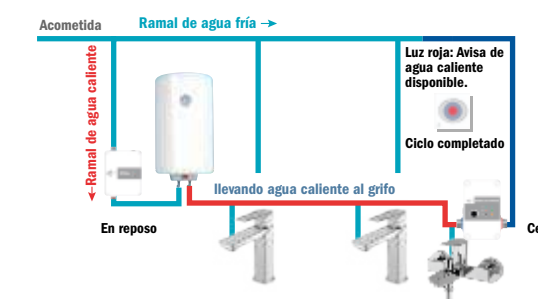
Fase C, fin: Termina el ciclo de recirculación por temperatura seleccionada.
