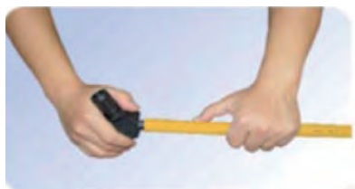
2.- Aborcardar y Redondear 2.- Abocardar e Arredondar
