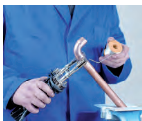
5. Aplicación de la soldadura 5. Aplicação da soldadura
