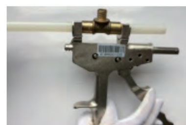
4. Colocar la unión entre las cunas de la prensa y comenzar a hacer presiones sucesivas hasta que pieza y casquillo hagan tope. 4. Coloque a união entre os berços da imprensa e começar a fazer pressões sucessivas até encostar peça e tampa.
