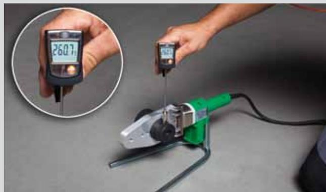
medición de temperatura en soldador (800W )
