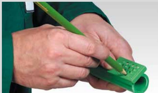
Marcar la profundidad de soldadura con galga
