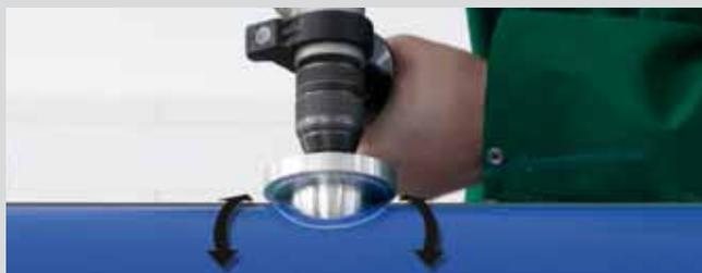
Remover la barrera de oxígeno en la tubería aquatherm blue pipe OT
