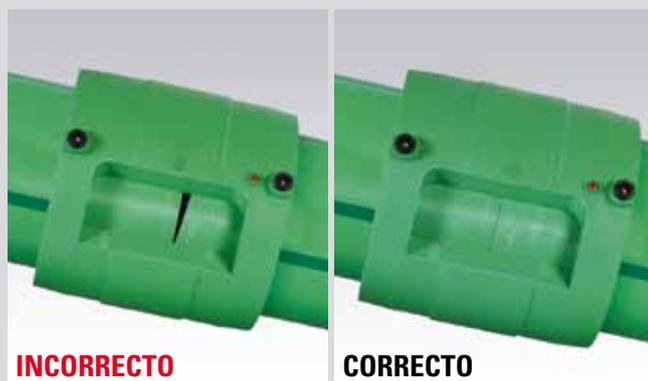
¡Para conseguir un resultado de soldadura óptimo, aquatherm recomienda que ambos extremos de la tubería estén puestos planoparalelos dentro del manguito electrosoldable!
