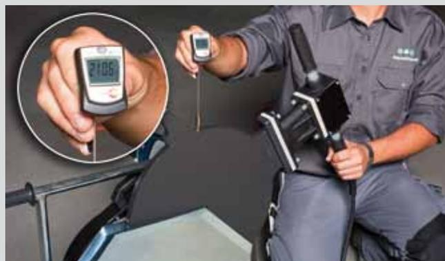
medición de temperatura en máquina de soldar a tope
