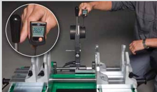
medición de temperatura en equipo de soldadura
