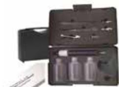
El Kit adaptador para la medición de turbidez se coloca sobre el fotómetro PrimeLab 1.0. **Incluye reactivos.** Medición a partir de 0,1 NTU.
