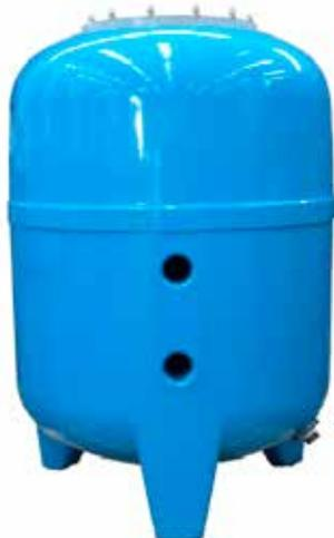
Filtro Calplas modelo HFS fabricado en poliéster reforzado con fibra de vidrio color azul RAL 5015. Tapa en metacrilato transparente: la tapa superior, muy grande, facilita la carga del medio filtrante y una mejor visualización del lavado del filtro. Lecho filtrante un 30-50% más alto que en el filtro FA, para una filtración óptima. Altura del lecho filtrante entre 600 y 800 mm. Toma de vaciado. Resistente a 1gr/m<sup>2</sup> de ozono. Válvula no incluida. Manómetro y purgador.
