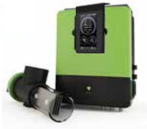
OXILIFE emplea dos métodos de desinfección para una perfecta esterilización del agua: hidrólisis, que rompe la molécula del agua generando agentes de desinfección a base de oxígeno (O<sub>3</sub>, O<sub>2</sub>, OH...) y electrólisis salina de baja salinidad (> 1,5 gr/l) para generar cloro residual en la piscina.
