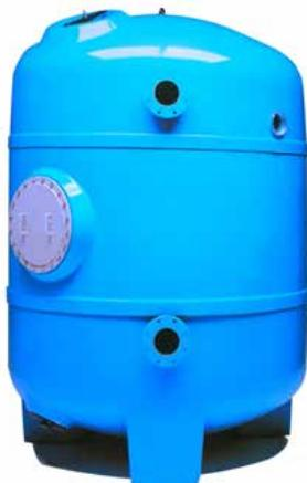
Filtro Calplas modelo DPS/420 fabricado en poliéster reforzado con fibra de vidrio color azul RAL 5015. **Altura del lecho filtrante 1.200mm.** Toma de vaciado. Resistente al ozono 1 gr/m<sup>2</sup>.
