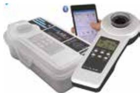
El fotómetro doméstico PoolLab lleva una cubeta incorporada pero intercambiable que permite un muestreo rápido del agua simplemente sumergiendo el aparato en la piscina. Lleva seis botones que permiten el acceso instantáneo a los parámetros siguientes:
