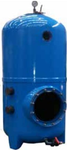
Filtro Calplas modelo AFM fabricado en poliéster reforzado con fibra de vidrio color azul RAL 5015. Tapa en metacrilato transparente. Toma de vaciado. Válvula no incluida. Resistente al ozono 1gr/m<sup>2</sup>. Manómetro y purgador. Boca de hombre y mirilla transparentes. Cámara de mezcla de floculantes. La mayor altura del lecho filtrante proporciona una filtración óptima. Altura del lecho 900 mm.
