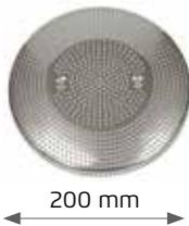
Las tomas de aspiración de Fitstar, fabricadas en bronce, están diseñadas para aspirar un gran caudal con la máxima seguridad gracias a su rejilla en acero inoxidable V4A de gran tamaño, con múltiples perforaciones y con varias superficies de aspiración, incluso en los laterales. Conexión rosca interior 2½".
