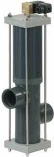
Válvula automática Besgo de 3 vías en PVC-U para aplicaciones alternativas y para enjuague del filtro. Partes interiores en acero inoxidable V4A 1.4571, juntas en Viton/PTFE resistentes al ozono.
