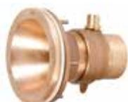
Nicho preinstalación en bronce Combi-Whirl tobera de masaje de pared con rosca interior de 2" y toma de venturi con conexión racord de 20 mm para piscinas prefabricadas.
