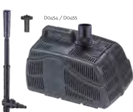
D0454 Altura máxima Jet: 1,7 m. caudal máximo: 1.000 l/h.
