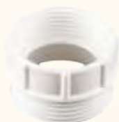
Adaptador. Reductor Macho 1" ½ - Hembra 1" ¼.
